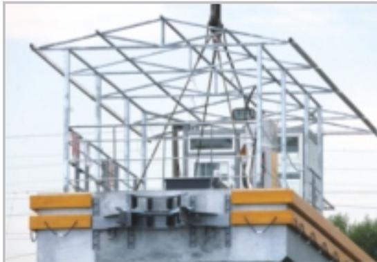
Все металлические конструкции на судне изготовлены из оцинкованного металла.
