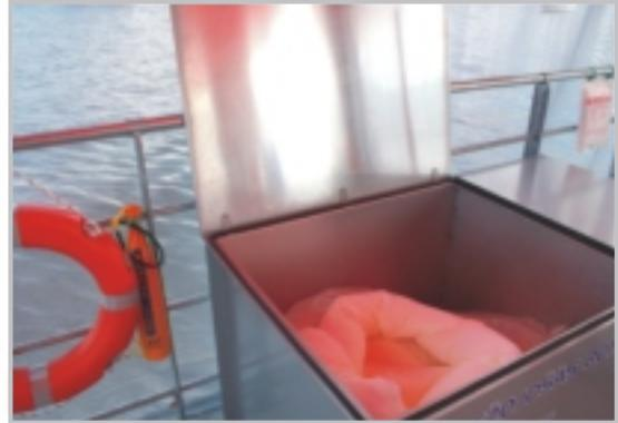
На стоечном нефтеналивном судне есть абсорбент, который используется для сбора пролившегося на платформу или в воду топлива. Есть также боны, ими ограничиваются пятна топлива вытекшего на поверхность воды.
