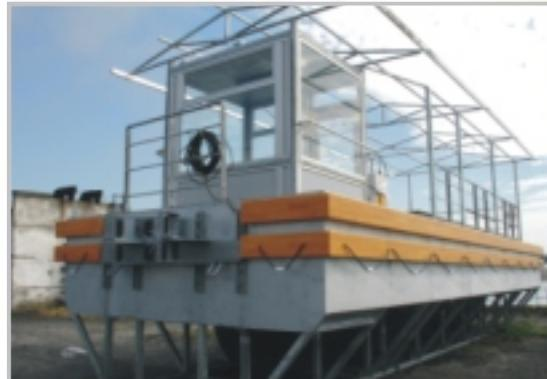
Топливный резервуар имеет двойные стены, кроме того, он встроен в металлический предохранительный каркас, призванный защитить от механических повреждений.
