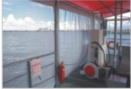
Палуба судна и ванны аварийных утечек топлива защищены от осадков специальным навесом (огнестойкая ткань, соответствующая группе горючести Г1). Ткань стенок навеса сетчатая, которая не пропускает капли косых дождей и в то же время уменьшает парусность при сильном ветре. На крыше и стенах навеса можно размещать рекламу.
