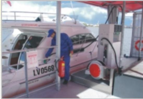
Высота надводного борта у судна Пилдне составляет примерно от 660 до 960 мм (в зависимости от наполнения топливных резервуаров). Это делает заправку топливом безопаснее и удобнее.
