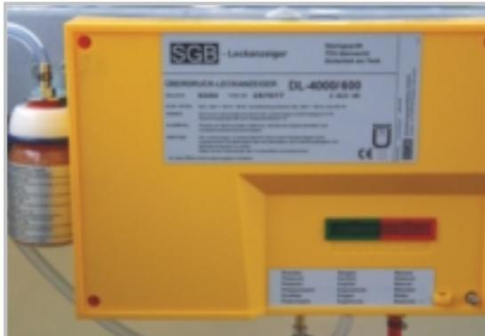
В межстенном пространстве двустенной емкости и двустенных трубопроводов содержится воздух под давлением 300 миллибар. Датчик утечки осуществляет постоянный контроль всей системы. Таким образом, гарантируется 100%-ная уверенность в исправном техническом состоянии судна. При малейшей неисправности, например падении давления контрольный датчик подает визуальный и звуковой сигналы.
